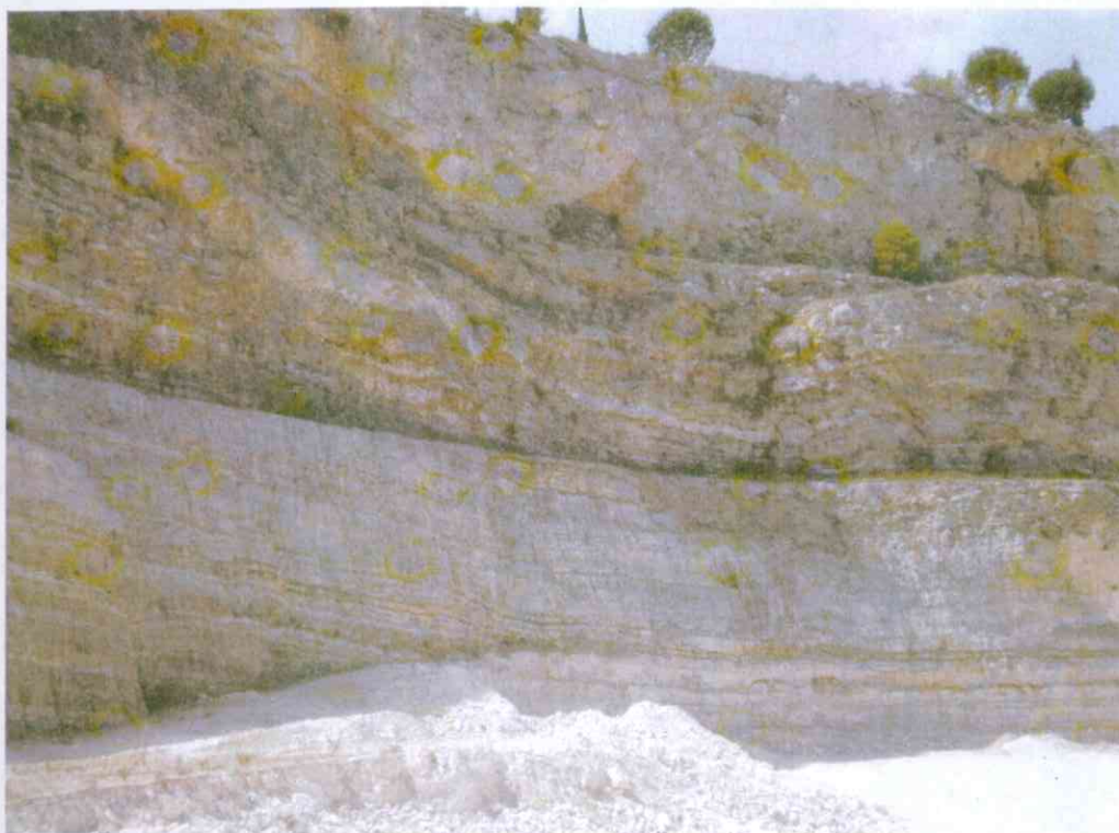
Foto 3 – Parte O caratterizzato da tre gradoni, con fronti alti dall'alto verso il basso 15, 12, e 12 metri. Calcare a stratificazione suborizzontale
