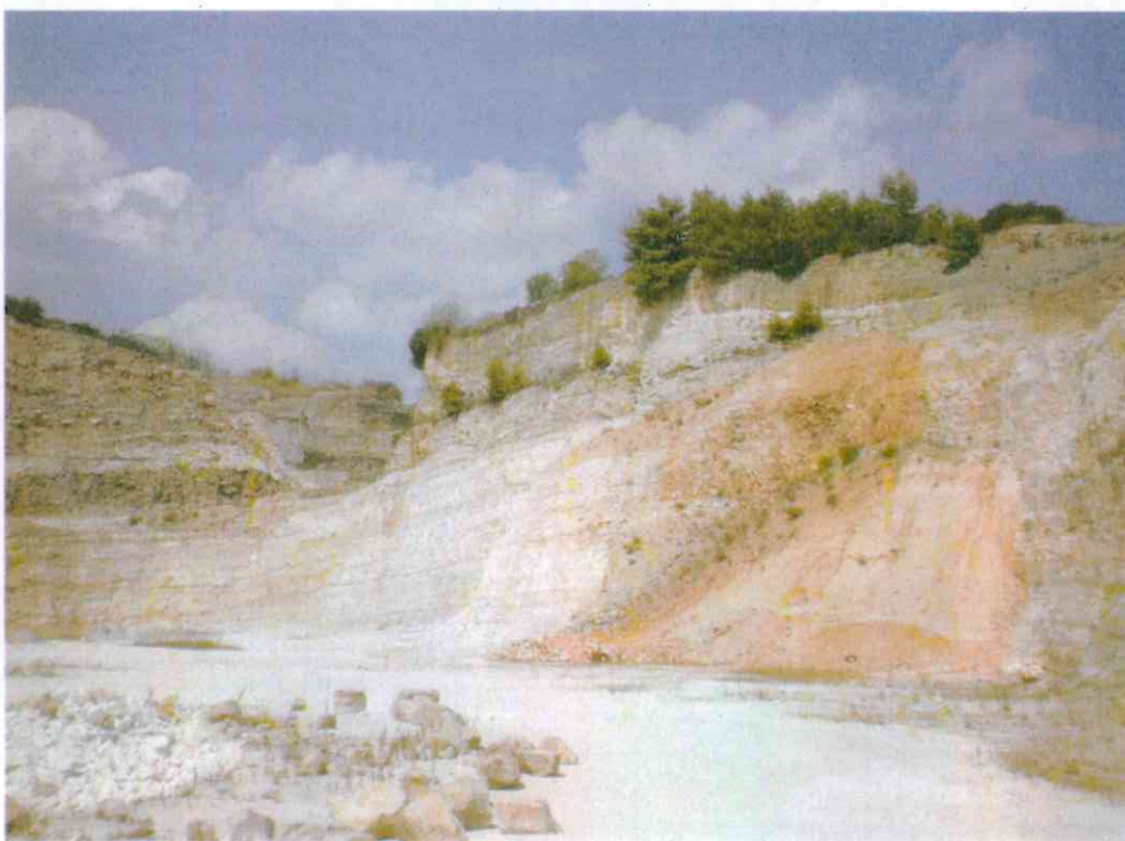
Foto 8 – Parte N caratterizzata da due gradoni, con fronte superiore rappresentato da calcarenite alto circa 10 metri e quello inferiore da calcare a stratificazione suborizzontale alto 20 metri. Nella parte più a Nord della cava si nota il contatto tettonico tra calcare e calcarenite
