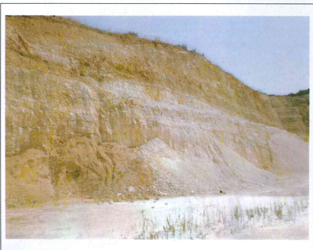
Foto 6 – Parte SSE caratterizzata da due gradoni, con fronte superiore alto 20 metri e quello inferiore 10 metri. Calcare a stratificazione suborizzontale ricoperta in superficie da un piccolo spessore di calcarenite
