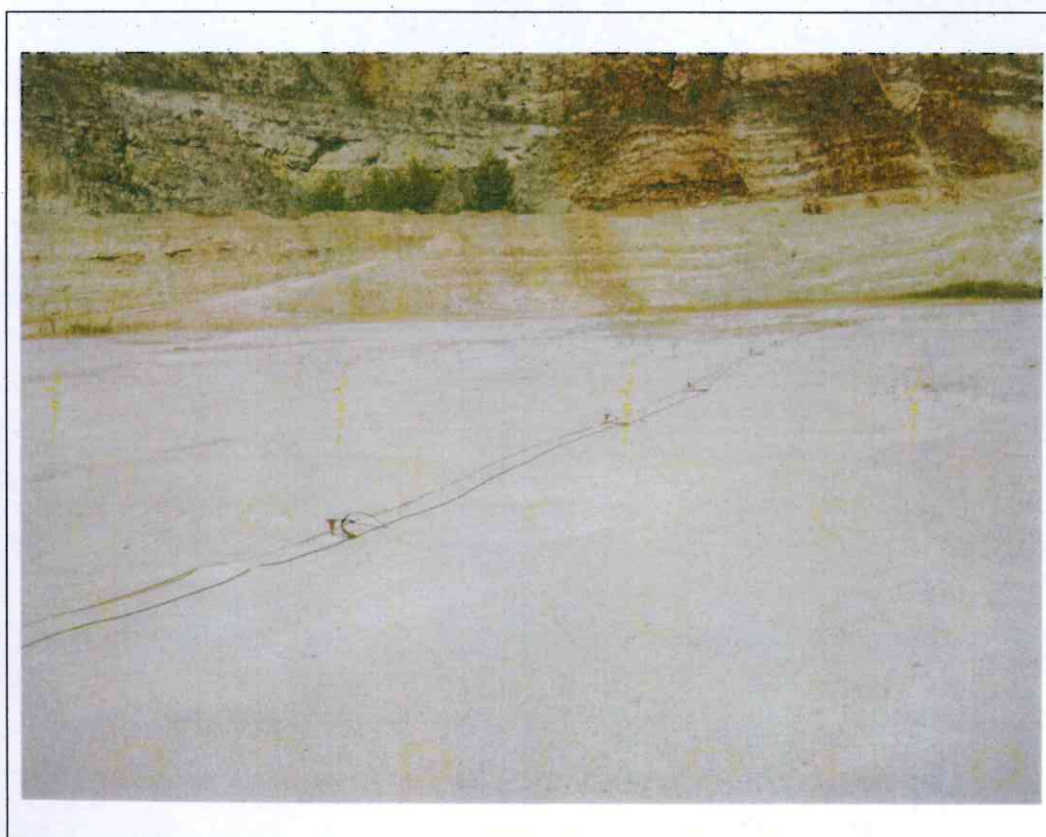
-Esecuzione profilo sismico passivo n°1
