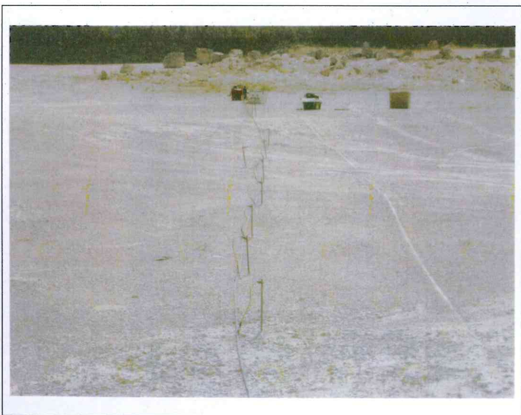
-Esecuzione profilo geoelettrico tomografico n°1
